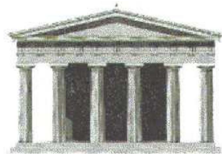
Templo dórico Portal São Francisco
